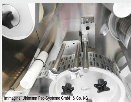
Riconoscimento corpo estraneo nei blister
